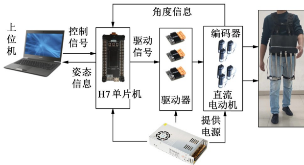
图11 髋关节康复机构的硬件系统结构图
