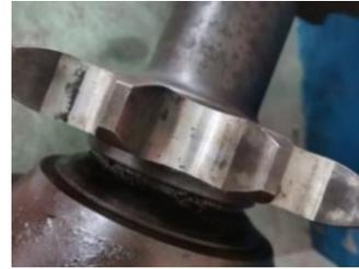
图12 链轮轮齿表面形貌
